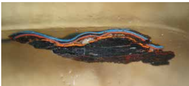
5 Poprečni presjek uzorka s podnice: iznad dvaju slojeva temeljnog premaza (donji je narančaste, a gornji crvene boje) nalaze se dva sloja završnog premaza i između njih tanki sloj bijele boje (kit?) (foto: S. M. Sunara)
